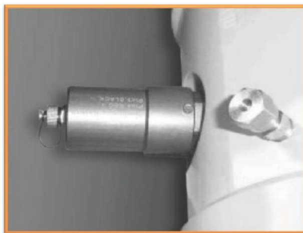
Figura 7: Sensor HF instalado e montado com o medidor turbina TBQM
