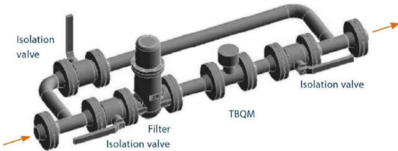
Figura 2: Instalação padrão horizontal para os medidores Turbina TBQM
