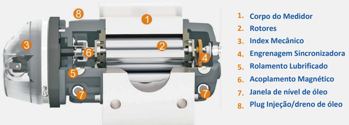
Figura 1: Visão em corte transversal do medidor rotativo TYL
