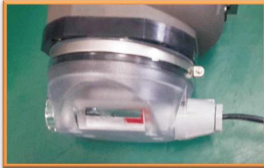
Figura 8: Sensor LF instalado e montado com o medidor rotativo TYL
